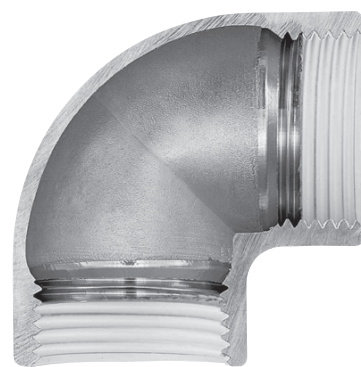
プレシールSUS継手の断面(写真) ねじ奥をプレシールしないことで端材の混入を防止、 接続部の緩み防止に効果あり
